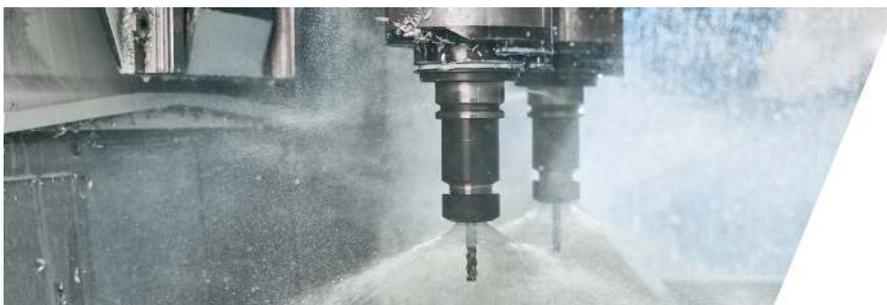
Alutronic bearbeitet mit modernster CNC-Doppelspindel-Technologie mittlere und große Serien schnell, präzise und wirtschaftlich.
